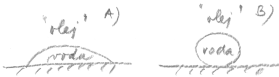
Obr. 36 Metoda selektivního smáčení. A) hydrofilní B) hydrofobní povrch
